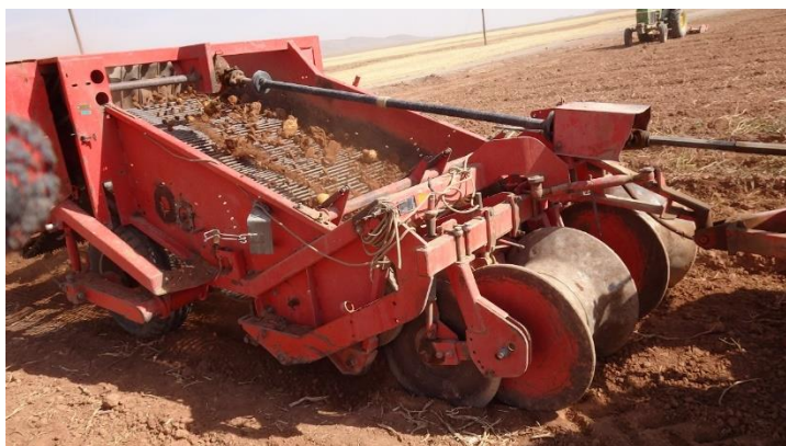
شکل ۴- ماشین برداشت گریمه در حال برداشت غده‌های سیب‌زمینی
