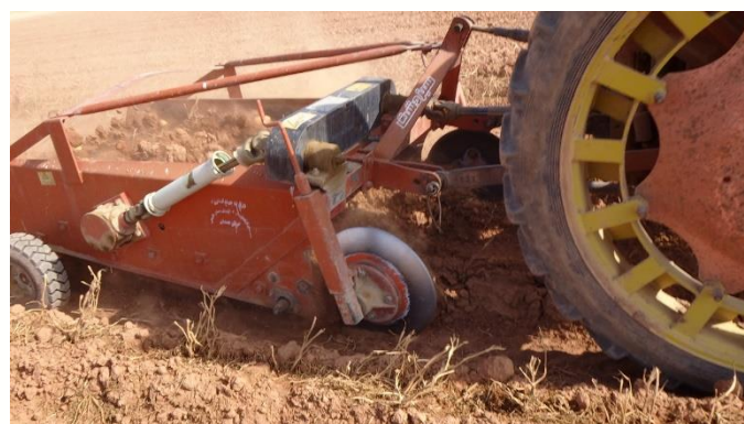
شکل ۵- ماشین برداشت سبزدشت در حال برداشت غده‌های سیب‌زمینی
