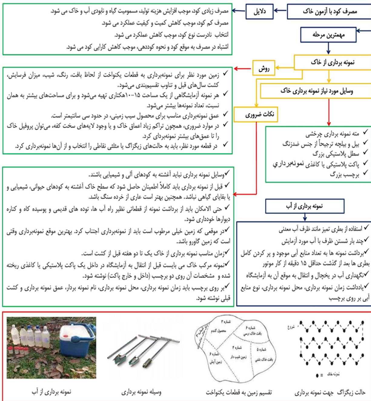
شکل ۲- شیوه نمونه برداری صحیح از منابع آب و خاک مزارع سیب زمینی
