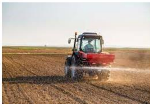
شکل ۱- کودپاش گریز از مرکز
