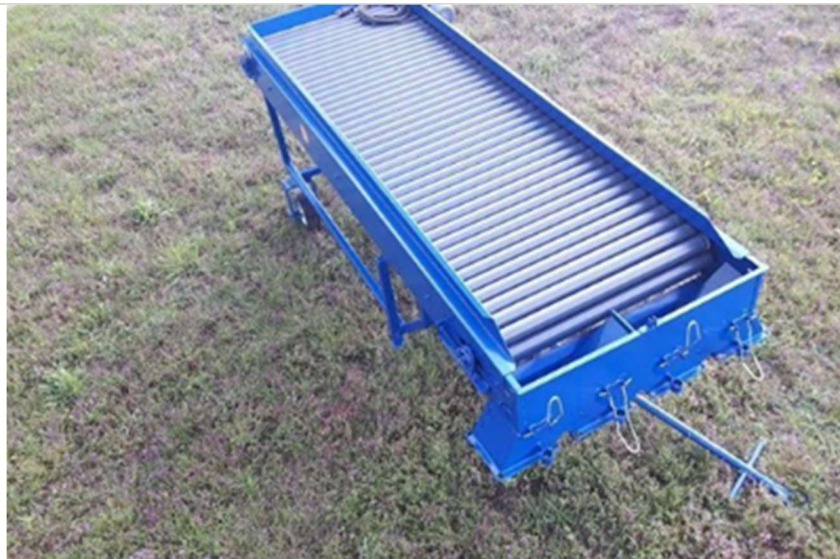
شکل ۳- وسیله‌ای ساده برای جداکردن خاک همراه سیب زمینی در مزرعه
