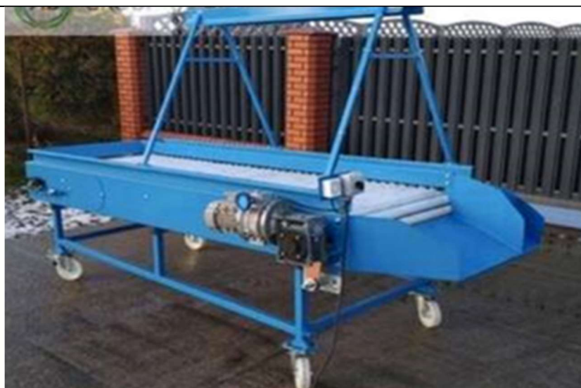
شکل ۴- وسیله‌ای ساده همراه با ایجاد لرزش برای جداکردن خاک همراه سیب زمینی در مزرعه
