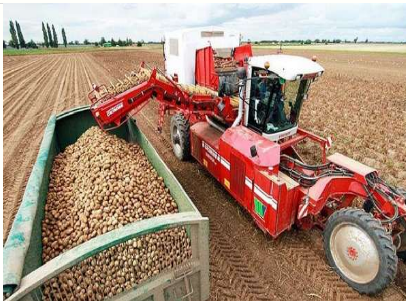
شکل ۵- ماشین برداشت سیب‌زمینی مجهز به قسمت جداسازی خاک همراه آن در مزرعه
