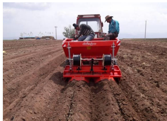
شکل ۱- مرحله کاشت با غده‌کار چهار ردیفه در روی دو پشته و در هر پشته دو ردیف با یک نوار تیپ
